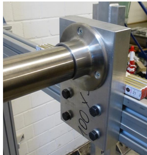
Bild 22 Befestigter Handlauf (Verglasungsgruppe 2)
