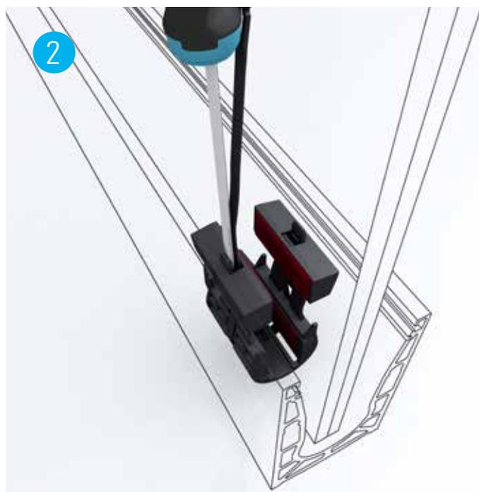
À l'aide d'un tournevis, desserrez le loquet pour libérer la cale de serrage supérieure.
