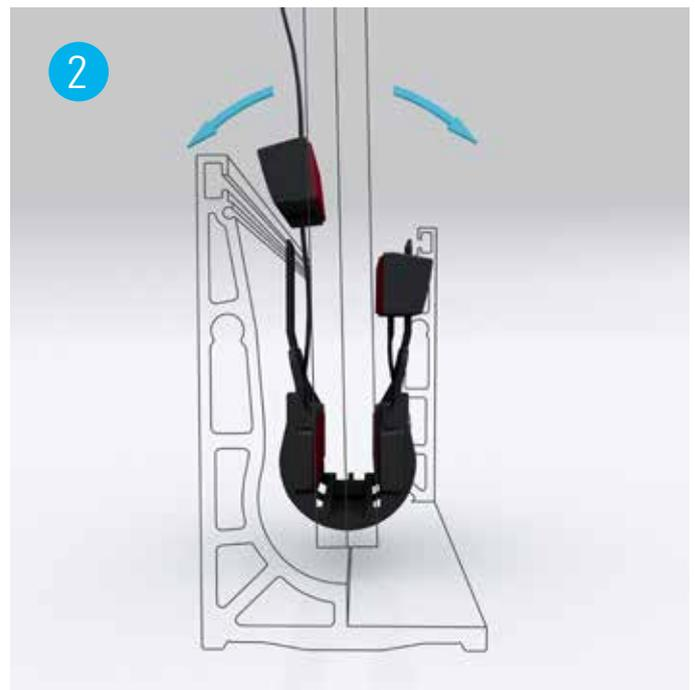
**Réglez l'inclinaison de la vitre** à la main sans outils ( $\pm 20$  mm pour une hauteur de vitre de 1 m). Les cales se déplacent de manière continue et simultanée dans le profilé.
