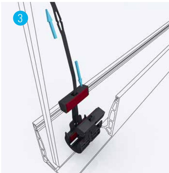
Pour **bloquer le verre**, il suffit de tirer sur la languette de tirage et, en même temps, d'engager fermement la cale de serrage - un principe aussi ingénieux que celui du serre-câble.
