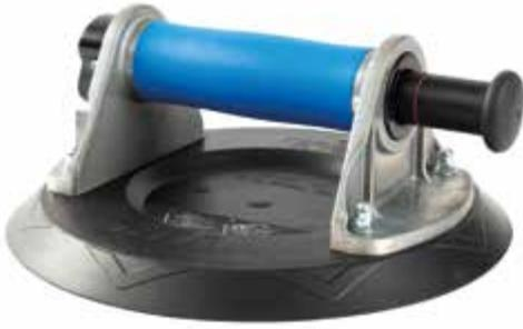
**i** Pumpensaugheber aus stabilem Aluminium für große Lasten. Griff mit rutschfester Ummantlung. Der abgerundete Pumpenstößel ermöglicht eine schnelle und bequeme Bedienung. Permanente visuelle Kontrolle des Vakuums durch den roten Ring am Pumpenstößel. Der Saugheber ist für alle Materialien mit planen und gasdichten Oberflächen geeignet. Durch die weichere Gummischeibe hat der Pumpensaugheber eine längere Haltedauer, weiterhin ist dieser für leicht strukturierte Oberflächen geeignet.
