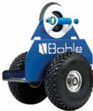
**i** Höhe 575 mm · Breite 410 mm · Traglast bis 300 kg · minimale Dicke des zu transportierenden Materials 3 mm · maximale Höhe zu transportierenden Materials 2000 mm · maximale Länge zu transportierenden Materials 3000 mm
