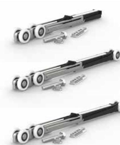
Amortisseurs en metal optionnels pour toutes les applications MasterTrack® BT. Ils sont équipés d'une hydraulique de qualité et de ressorts des deux côtés. Le freinage de la porte coulissante s'effectue en douceur et de manière fluide en un seul mouvement grâce aux amortisseurs. Un amortisseur de fermeture remplace un chariot à roulettes.
