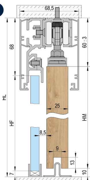
Montage au plafond / 1 vantail / avec vitrage fixe
