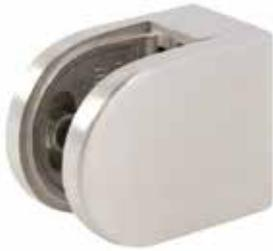
① Juntas disponibles como accesorios · Pin de seguridad incl. · Unidad de embalaje 4 unidades · Espesor vidrio templado 6 - 12 mm, vidrio laminado 8,76 - 12,76 mm · Si se utiliza vidrio laminado de seguridad se debe usar un dispositivo antideslizamiento.
