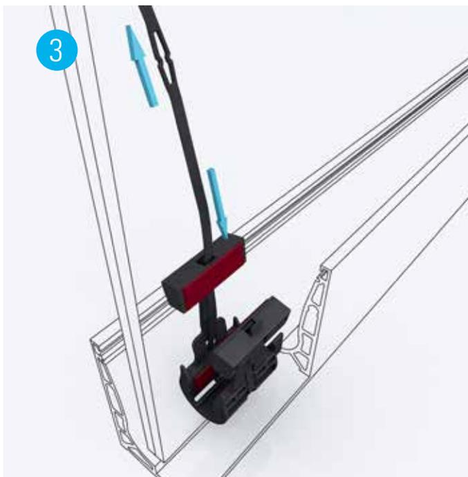
Para anclar el vidrio, se tira de la banda tensora y a la vez se encaja la cuña de sujeción superior. Tan ingenioso como el principio de funcionamiento de la brida.
