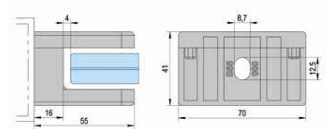
❗ Spannweiten bis zu 2000mm · Einlagen bitte separat bestellen · inkl. Sicherungsplatte · Verpackungseinheit 4 Stück · Glasdicke VSG 16,76 - 21,52 mm · Bei der Verwendung von VSG muss eine Abrutschsicherung eingesetzt werden.
