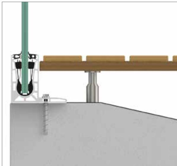
Verwendung des Profils an einem Gefälle. Der Boden ist auf Höhe des Profils aufgeständert.
