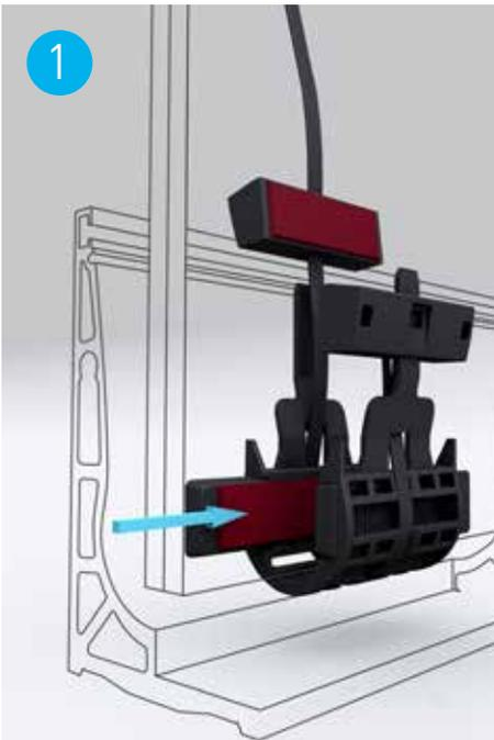
Zum **Fixieren der Glasscheibe** den unteren Fixierkeil zur Seite drücken. Gelingt am einfachsten mit der Montagehilfe von Seite 43.
