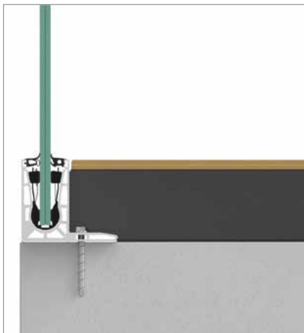
Für einen bündigen Abschluss des oberen Profils mit dem Boden dient ein gegossener Estrichbelag.
