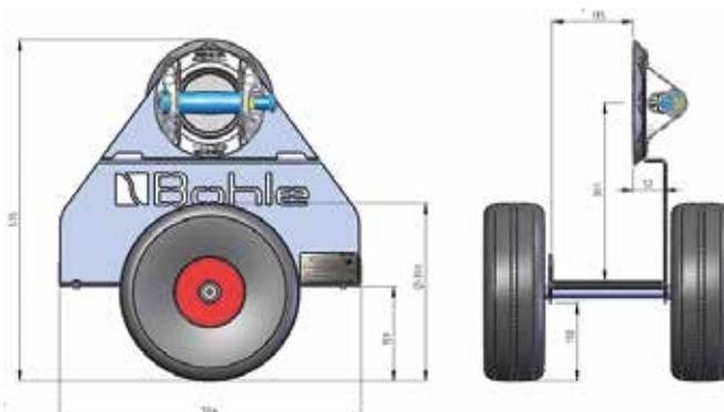
**i** Höhe 575 mm · Breite 410 mm · Traglast bis 300 kg · minimale Dicke des zu transportierenden Materials 3 mm · maximale Höhe zu transportierenden Materials 2000 mm · maximale Länge zu transportierenden Materials 3000 mm
