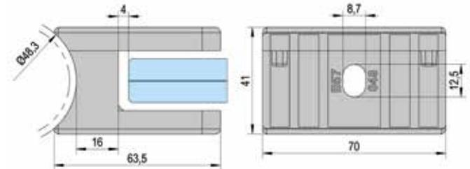
**i** Spannweiten bis zu 2000mm · Einlagen bitte separat bestellen · inkl. Sicherungsplatte · Verpackungseinheit 4 Stück · Glasdicke VSG 16,76 - 21,52 mm · Bei der Verwendung von VSG muss eine Abrutschsicherung eingesetzt werden.
