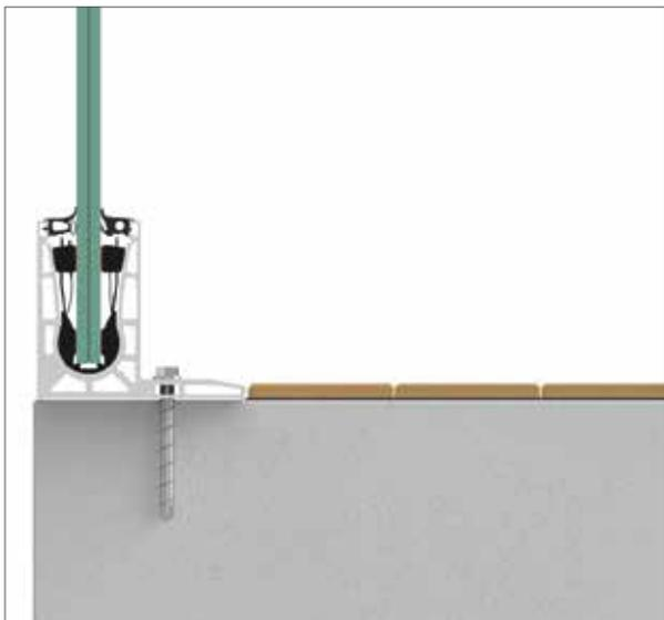
Das Bodenprofil F schließt sowohl links bündig mit der Baukante als auch mit dem Boden auf der rechten Seite ab.
