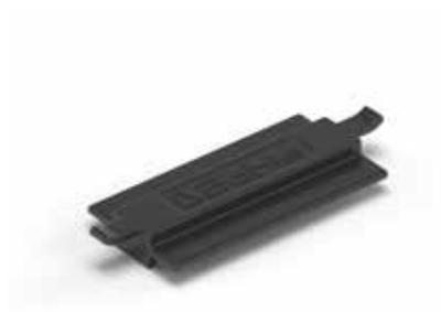
Der Vetromount® Photovoltaik-Distanzklotz für Glaslager erhöht den Abstand zwischen Glas und Profilboden und ermöglicht so die Positionierung der PV-Anschlussdosen an der Glasunterkante. Dadurch kann eine unsichtbare Verkabelung innerhalb des Grundprofils erfolgen.
