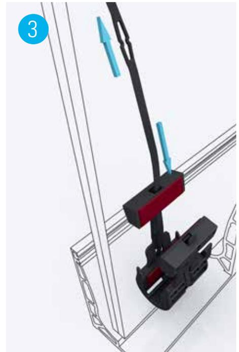
Zum **Verankern der Scheibe** am Zugband ziehen und gleichzeitig den oberen Spannkeil sicher einrasten – so genial wie das Prinzip des Kabelbinders.
