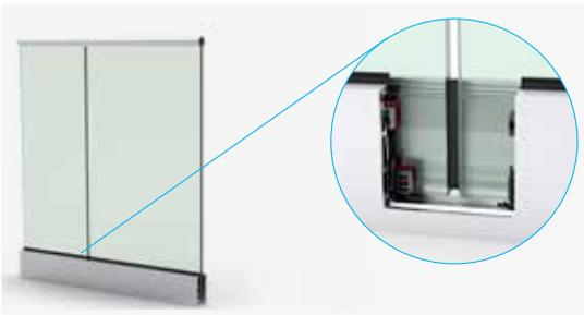
Unsere Distanzgummis sind in 1 m Länge und 5 bzw. 10 mm Stärke passend für die verschiedenen Glasdicken erhältlich. Diese können entsprechend des Bedarfs in kurze Stücke (ca. 3 cm) zugeschnitten werden. Sie sind einseitig klebend und werden bündig zur oberen Dichtungsprofilkante zwischen die Glasscheiben positioniert. Somit dienen sie gleichzeitig als Abstandshalter und Abdichtungsprofil zwischen den Glasscheiben.
