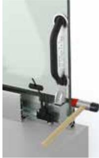
Die Montagehilfe unterstützt bei der Feststellung der Glaslager. Durch Klopfen des Hammers auf den gekennzeichneten Punkt wird der untere Fixierkeil nach rechts gedrückt und fixiert somit sicher die Glasscheibe. Die Montagehilfe kommt ebenfalls bei der Demontage zum Einsatz.
