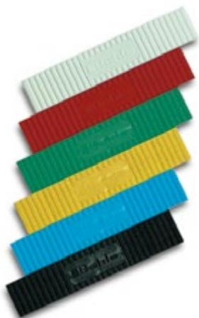
**i** Geprüftes, dichtungstoffverträgliches Material · universell einsetzbar durch quengeriffelte Oberfläche und stabile Unterseite · die Form der Klötze garantiert eine bündige Anschlagverklotzung an der Glasfalzinnenkante · Hergestellt in Übereinstimmung mit den Technischen Richtlinien des Glaserhandwerks Nr. 3 "Klotzung von Verglasungseinheiten" · Tragfähigkeit pro Klotz max. 300 kg · Verpackungseinheit 100 Stück.
