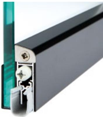
➊ Ideal für das Abdichten von Glastüren · Dichtungen können selbstständig gekürzt werden, bitte beachten Sie die Mindestlänge · für DIN-L und DIN-R Türen geeignet · einseitige Auslösung · Schallschutz 41 dB.
