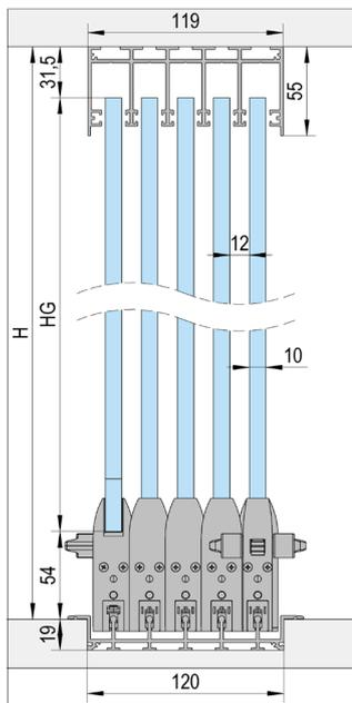
Montage avec rail de roulement encastré / 5 vantaux
