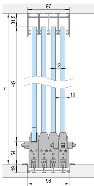
Montage avec rail de roulement encastré / 4 vantaux
