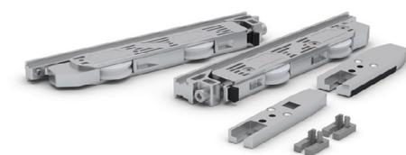
Le set d'accessoires FloorTrack pour vantail A1 comprend tous les composants pour un vantail de fermeture sans verrouillage au bord de l'installation à plusieurs vantaux et des caches qui font office d'entraîneurs. Les composants sont simplement introduits et fixés latéralement dans le profilé pour le verre.
