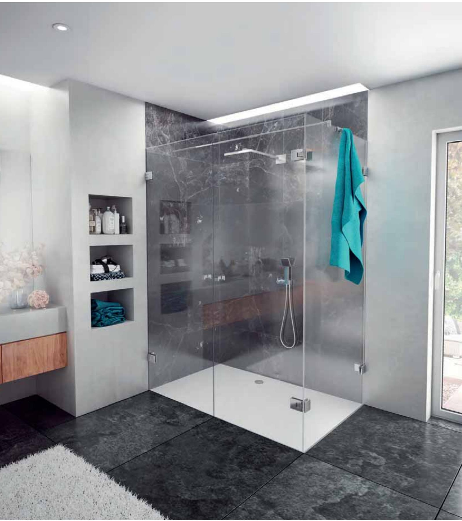
Das Pendelduschtürband Juna® Glas-Wand 90° hat eine Tragkraft von 50 kg. Es lassen sich Türen bis zu 1 x 2,25 m realisieren. Das Band ist für rechteckige Eckduschen und Nischenduschen konzipiert. Die Verschraubung an der Wand erfolgt in zwei Langlöchern und einer Sicherungsbohrung.
