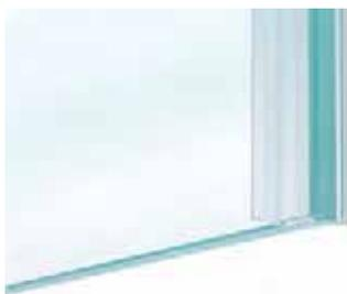
Duschtürdichtungen mit Eckanschlag eignen sich für im 90° Winkel angeordnete Festverglasungen und kommen ausschließlich bei Anschlagtüren zum Einsatz. Eine zusätzliche, weiche Dichtlippe dient als leichter Anschlagpuffer für die Tür. Die Dichtung wird einfach auf die Glaskante aufgesteckt.
