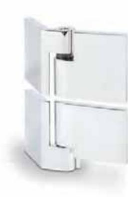
Das flächenbündige Pendelduschtürband Plan Artist FM hat eine Tragkraft von 38 kg. Es lassen sich Türen bis zu max. 0,9 x 2,10 m realisieren. Das Band ist zum Beispiel für die moderne und platzsparende, fünfeckige Dusche konzipiert. Es sind nur einfache Glasbohrungen im Seitenteil erforderlich. Zum bündigen Abschluss mit dem Beschlag ist im Glasausschnitt ein Abzugsmaß von 16 mm berücksichtigt. Um die Dichtung BO 5213494 einzusetzen, muss der Glasausschnitt angepasst werden.
