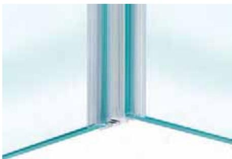
Diese Duschtürdichtung mit 90° Magnetprofil eignet sich für im 90° Winkel angeordnete Festverglasungen in Kombination mit einer Pendeltür. Der Magnet sorgt für eine sichere Zuhaltung und erleichtert das Schließen der Tür. Die Dichtung wird einfach auf die Glaskante aufgesteckt.
