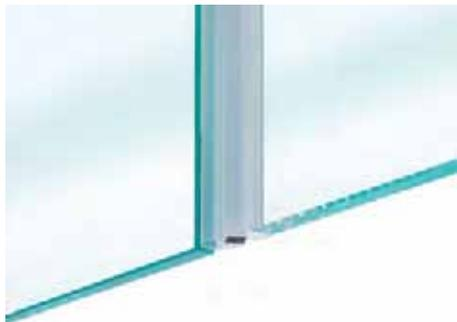
Diese Duschtürdichtung mit 180° Magnetprofil eignet sich für fluchtend angeordnete Festverglasungen in Kombination mit einer Anschlagtür. Der Magnet sorgt für eine sichere Zuhaltung und erleichtert das Schließen der Tür. Die Dichtung ist selbstklebend mit vormontiertem 3M-Klebeband.
