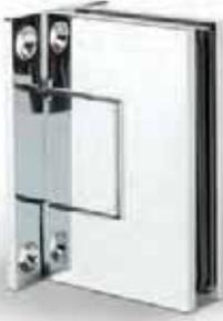
Das Pendelduschtürband Bilbao Premium Glas-Wand 90° hat eine Tragkraft von 40 kg. Es lassen sich Türen bis zu max. 1 x 2 m realisieren. Das Band ermöglicht die Montage einer Glastür an einer Wand, beispielsweise für klassische Nischen- oder 90°-Eckduschen.
