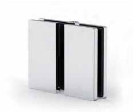
Der Winkelverbinder ist mit nur einer Schraube zwischen 45-180° frei einstellbar. Er kann wahlweise für Glas-Glas oder Glas-Wand Anwendungen eingesetzt werden, um eine Wand mit einem Glasseitenteil oder zwei feststehende Glasseitenteile in einem nahezu beliebigen Winkel zu verbinden.
