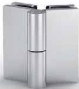
Das Anschlagduschtürband Arta Glas-Glas 135° hat eine Tragkraft von 40 kg. Es lassen sich Türen bis zu 1 x 2 m realisieren. Das Band besitzt eine Hebe-Senkfunktion und ist zum Beispiel für die moderne und platzsparende, fünfeckige Dusche konzipiert.
