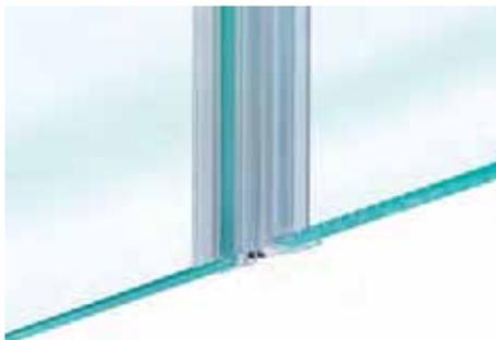
Diese Duschtürdichtung mit 180° Magnetprofil eignet sich für eine fluchtend angeordnete Anschlagtür in Kombination mit einer Festverglasung. Der Magnet sorgt für eine sichere Zuhaltung und erleichtert das Schließen der Tür. Die Dichtung wird einfach auf die Glaskante aufgesteckt.
