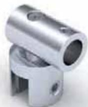
Glasanschluss passend zur Stabilisationsstange Round 12, dient zur Verbindung eines festen Glaseitenteils mit einer Stabilisationsstange. Dieser Glasanschluss wird auf die obere Glaskante geklemmt und ist im Winkel frei verstellbar.
