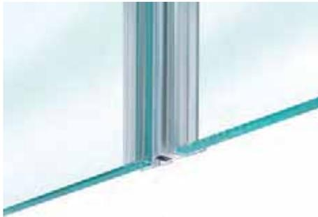
Diese Duschtürdichtung mit 180° Magnetprofil eignet sich für eine fluchtend angeordnete Pendeltür in Kombination mit einer Festverglasung. Der Magnet sorgt für eine sichere Zuhaltung und erleichtert das Schließen der Tür. Die Dichtung wird einfach auf die Glaskante aufgesteckt.
