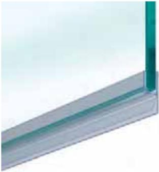
Duschtürdichtungen mit Frontanschlag eignen sich für fluchtend angeordnete Festverglasungen und kommen ausschließlich bei Anschlagtüren zum Einsatz. Eine zusätzliche, weiche Dichtlippe dient als leichter Anschlagpuffer für die Tür. Die Dichtung wird einfach auf die Glaskante aufgesteckt.
