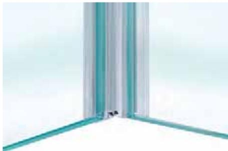
Duschtürdichtungen mit 90° Magnetprofil eignen sich sowohl für die Kombination Festverglasung mit Tür als auch für Eckeinsteige und kommen nur bei Anschlagtüren zum Einsatz. Der Magnet sorgt für eine sichere Zuhaltung und erleichtert das Schließen der Tür.
