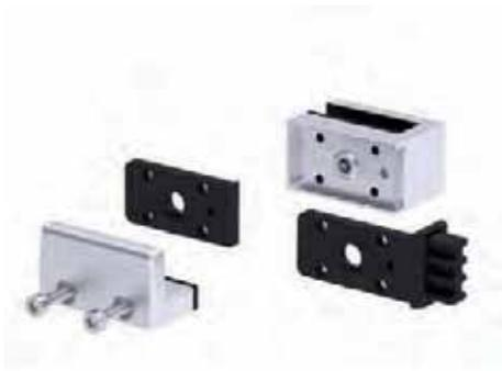
Die zweiteilige MasterTrack® ST Bodenführung ermöglicht eine einfache Montage der Tür und lässt sich durch auswechselbare Einsatzstücke auf die Anwendung mit optionalem Schwallenschutz vorrichten. Die Befestigung erfolgt durch Klemmung an der Festverglasung.
