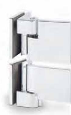
Das flächenbündige Pendelduschtürband Plan Artist FM hat eine Tragkraft von 38 kg. Es lassen sich Türen bis zu max. 0,9 x 2,10 m realisieren. Das Band ist für die Anbringung einer Tür an ein feststehendes Glasseitenteil konzipiert. Es sind lediglich einfache Glasbohrungen im Seitenteil erforderlich. Zum bündigen Abschluss mit dem Beschlag ist im Glasausschnitt ein Abzugsmaß von 16 mm berücksichtigt. Um die Dichtung BO 5213494 einzusetzen, muss der Glasausschnitt angepasst werden.
