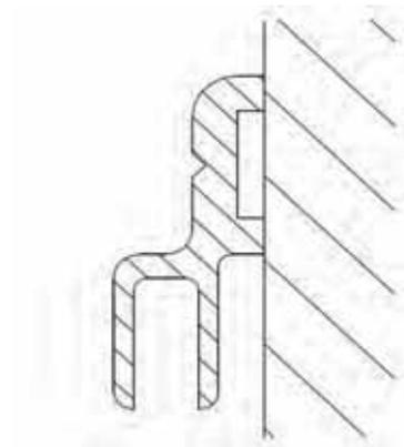
Der Magnetleistenträger ermöglicht das Aufstecken einer Magnetdichtung für Nischensituationen.
