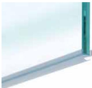
Duschtürdichtungen mit offener Dichtlippe eignen sich sowohl für die Griffseite als auch für die Bandseite und kommen aufgrund ihrer asymmetrischen Form insbesondere bei Anschlagtüren zum Einsatz. Die Dichtung wird einfach auf die Glaskante aufgesteckt.
