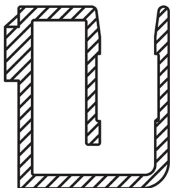
Das Badewannenaufsatzprofil ermöglicht die Kombination von Dusche und Badewanne.
