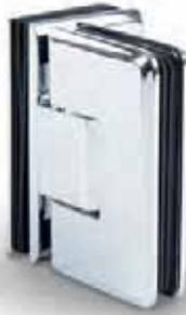
Das Pendelduschtürband Bilbao Select Glas-Glas 90° hat eine Tragkraft von 40 kg. Es lassen sich Türen bis zu max. 1 x 2 m realisieren. Das Band für die 90° Glas-Glas Montage ist für die Anbringung einer Tür an ein feststehendes Glaseitenteil konzipiert.
