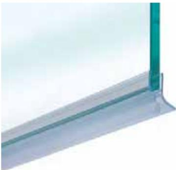
Duschtürdichtungen mit Wasserabweiser und unterem Balg eignen sich insbesondere für die Unterseite und kommen sowohl bei Anschlag- als auch bei Pendeltüren zum Einsatz. Die Dichtung wird einfach auf die Glaskante aufgesteckt.
