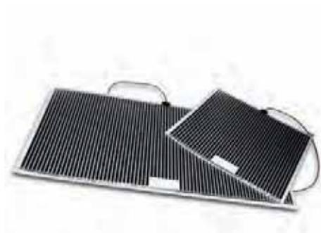
Die Spiegelheizungen verhindern das Beschlagen der Badezimmerspiegel. Die selbstklebende Heizfolie wird auf die Spiegelrückseite geklebt. Elektrische Leiter in der Folie heizen den Spiegel auf ungefährliche ca. 30 °C auf. Die Bildung von Kondenswasser wird so wirksam vermieden.
