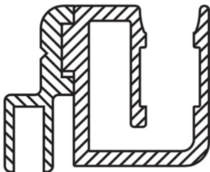
Durch die Kombination des Badewannenaufsatzprofils und dem Magnetleistenträger läuft die Magnetdichtung von oben nach unten in einem Stück durch. Dadurch kann die Zuhaltung der Duschtür erreicht werden.
