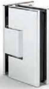
Das Pendelduschtürband Bilbao Select Glas-Wand 90° hat eine Tragkraft von 40 kg. Es lassen sich Türen bis zu max. 1 x 2 m realisieren. Das Band ermöglicht die Montage einer Glastür an einer Wand, beispielsweise für klassische Nischen- oder 90°-Eckduschen.
