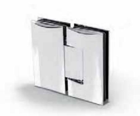
Das Pendelduschtürband Art Glas-Glas 180° hat eine Tragkraft von 35 kg. Es lassen sich Türen bis zu max. 0,75 x 2 m realisieren. Das Band für die 180° Glas-Glas Montage eignet sich für die fluchtende Montage einer Glastür an ein feststehendes Glasseitenteil.
