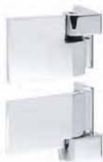
Das flächenbündige Pendelduschtürband Plan Artist FM hat eine Tragkraft von 38 kg. Es lassen sich Türen bis zu max. 0,9 x 2,10 m realisieren. Die 90° Glas-Wand Montage ist für rechtwinklige Eckduschen und Nischenduschen konzipiert. Zum bündigen Abschluss mit dem Beschlag ist im Glasausschnitt ein Abzugsmaß von 16 mm berücksichtigt. Um die Dichtung BO 5213494 einzusetzen, muss der Glasausschnitt angepasst werden.
