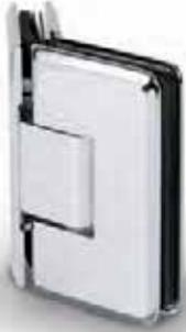
Das Pendelduschtürband Barcelona Select Glas-Glas 135° hat eine Tragkraft von 40 kg. Es lassen sich Türen bis zu 1 x 2 m realisieren. Das Band für die 135° Glas-Glas Montage ist zum Beispiel für die moderne und platzsparende, fünfeckige Dusche konzipiert.
