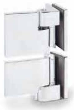
Das flächenbündige Pendelduschtürband Plan Artist FM hat eine Tragkraft von 38 kg. Es lassen sich Türen bis zu max. 0,9 x 2,10 m realisieren. Das Band ist für die Anbringung einer Tür an ein feststehendes Glasseitenteil konzipiert. Es sind lediglich einfache Glasbohrungen im Seitenteil erforderlich. Zum bündigen Abschluss mit dem Beschlag ist im Glasausschnitt ein Abzugsmaß von 16 mm berücksichtigt. Um die Dichtung BO 5213494 einzusetzen, muss der Glasausschnitt angepasst werden.
