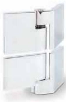
Das flächenbündige Pendelduschtürband Plan Artist FM hat eine Tragkraft von 38 kg. Es lassen sich Türen bis zu max. 0,9 x 2,10 m realisieren. Das Band ist zum Beispiel für die moderne und platzsparende, fünfeckige Dusche konzipiert. Es sind nur einfache Glassenkböhrungen im Seitenteil erforderlich. Zum bündigen Abschluss mit dem Beschlag ist im Glasausschnitt ein Abzugsmaß von 16 mm berücksichtigt. Um die Dichtung BO 5213494 einzusetzen, muss der Glasausschnitt angepasst werden.
