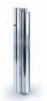
Das Aluminium-Profil-System Aqua für die Duschtür hat eine Tragkraft von 37 kg. Es lassen sich je nach Glasstärke Pendeltüren mit Gesamtmaßen bis zu max. 0,9 x 2,2 m realisieren. Es handelt sich um ein durchgängiges 90° Glas-Wand Profil.
