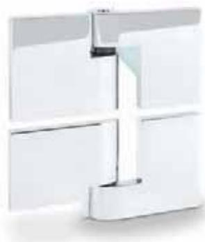
Das Pendelduschtürband Plan Artist FM hat eine Tragkraft von 38 kg. Es lassen sich Türen bis zu max. 0,90 x 2,10 m realisieren. Das Band für die 180° Glas-Glas Montage ist für moderne, große Duschräume aus Glas entwickelt worden. Es sind nur einfache Glassenbohrungen im Seitenteil erforderlich. Zum bündigen Abschluss mit dem Beschlag ist im Glasausschnitt ein Abzugsmaß von 16 mm berücksichtigt. Um die Dichtung BO 5213494 einzusetzen, muss der Glasausschnitt angepasst werden.
