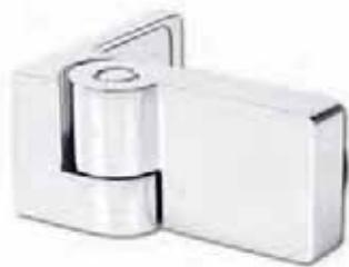
Das flächenbündige Duschtürband Lugo FM hat eine Tragkraft von 36 kg. Es lassen sich Türen bis zu max. 0,9 x 2,00 m realisieren. Mit der 90° Glas-Wand Montage ist das Band für Nischenduschen und klassische 90° Eckduschen konzipiert.
