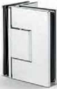
Das Pendelduschtürband Bilbao Premium Glas-Glas 90° hat eine Tragkraft von 40 kg. Es lassen sich Türen bis zu max. 1 x 2 m realisieren. Das Band für die 90° Glas-Glas Montage ist für die Anbringung einer Tür an ein feststehendes Glaseitenteil konzipiert.
