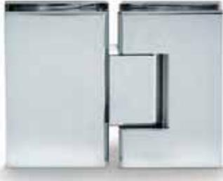
Das Pendelduschtürband Bilbao Glas-Glas 180° hat eine Tragkraft von 36 kg. Es lassen sich Türen bis zu 0,9 x 2 m realisieren. Das Band für die 180° Glas-Glas Montage ist für moderne, große Duschräume aus Glas entwickelt worden.
