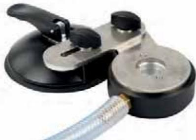
Die Anbohrhilfe Profi mit Wasserzuführung / Wasserauffangablauf ermöglicht präzises Bohren bei minimaler Verschmutzung des Umfeldes. Der Bohrstaub wird mit dem Kühlwasser aus der abgedichteten Schmutzkammer über den Abflussschlauch abgeleitet (Abdichtung zur Fliese und zum Bohrer).
