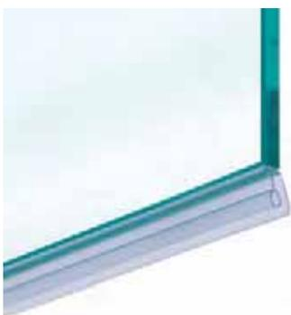
Duschtürdichtungen mit Wasserabweiser und unterem Balg eignen sich für die Unterseite und kommen sowohl bei Anschlag- als auch bei Pendeltüren zum Einsatz. Die Dichtung wird einfach auf die Glaskante aufgeklebt. Selbstklebende Dichtungen verfügen über ein vormontiertes 3M-Klebeband.
