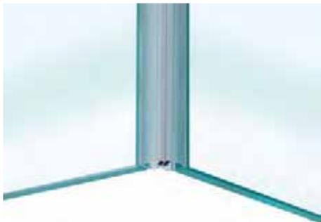
Duschtürdichtungen mit 90° Magnetprofil eignen sich sowohl für im 90° Winkel angeordnete Festverglasungen als auch für Eckeinsteige und kommen ausschließlich bei Anschlagtüren zum Einsatz. Der Magnet sorgt für eine sichere Zuhaltung und erleichtert das Schließen der Tür. Die Dichtung ist selbstklebend mit vormontiertem 3M-Klebeband.
