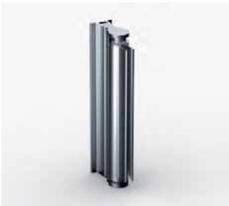
Das Aluminium-Profil-System Aqua für die Duschtür hat eine Tragkraft von 37 kg. Es lassen sich je nach Glasstärke Pendeltüren mit Gesamtmaßen bis zu max. 0,9 x 2,2 m realisieren. Es handelt sich um ein durchgängiges 90° Glas-Wand Profil.
