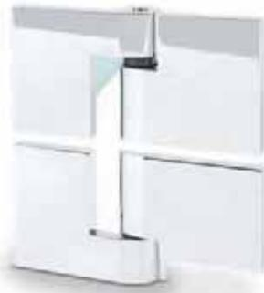
Das Pendelduschürband Plan Artist FM hat eine Tragkraft von 38 kg. Es lassen sich Türen bis zu max. 0,90 x 2,10 m realisieren. Das Band für die 180° Glas-Glas Montage ist für moderne, große Duschräume aus Glas entwickelt worden. Es sind nur einfache Glassenkbohrungen im Seitenteil erforderlich. Zum bündigen Abschluss mit dem Beschlag ist im Glasausschnitt ein Abzugsmaß von 16 mm berücksichtigt. Um die Dichtung BO 5213494 einzusetzen, muss der Glasausschnitt angepasst werden.
