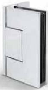
Das Pendelduschtürband Bilbao Premium HD Glas-Wand 90° hat eine Tragkraft von 50 kg. Es lassen sich Türen bis zu max. 1 x 2 m realisieren. Das Band ermöglicht die Montage einer Glastür an einer Wand, beispielsweise für klassische Nischen- oder 90°-Eckduschen.
