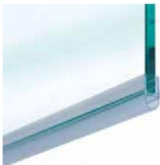
Duschtürdichtungen mit Balg eignen sich sowohl für die Griffseite als auch für die Bandseite und kommen aufgrund ihrer symmetrischen Form insbesondere bei Pendeltüren zum Einsatz. Die Dichtung wird einfach auf die Glaskante aufgesteckt.
