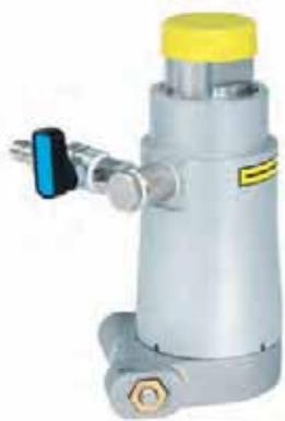
Die Wasserspülbüchse ist für Diamanthohlbohrer mit 1/2" Gewindeanschluss geeignet und passt zu allen üblichen Bohrmaschinen mit Spannhalsdurchmesser 43 mm (Maulschlüssel 24 mm).
