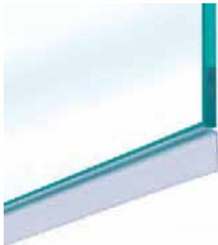
Duschtürdichtungen mit Wasserabweiser eignen sich sowohl für die Bandseite als auch für die Unterseite und kommen sowohl bei Anschlag- als auch bei Pendeltüren zum Einsatz. Die Dichtung wird einfach auf die Glaskante aufgeklebt. Selbstklebende Dichtungen verfügen über ein vormontiertes 3M-Klebeband.
