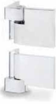
Das flächenbündige Pendelduschtürband Plan Artist FM hat eine Tragkraft von 38 kg. Es lassen sich Türen bis zu max. 0,9 x 2,10 m realisieren. Die 90° Glas-Wand Montage ist für rechteckige Eckduschen und Nischenduschen konzipiert. Zum bündigen Abschluss mit dem Beschlag ist im Glasausschnitt ein Abzugsmaß von 16 mm berücksichtigt. Um die Dichtung BO 5213494 einzusetzen, muss der Glasausschnitt angepasst werden.
