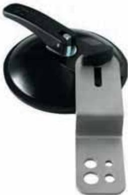
Die Anbohrhilfe für Dübelbohrer im Durchmesser 6, 8, 10, 12 mm ermöglicht präzises Bohren. Die Anbohrhilfe hat eine justierbare Bohrplatte. Die Dichtlippe am Sauger ist auch für rauere Untergründe geeignet.
