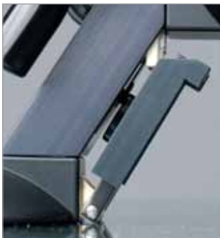
Aanslagklauw voor precieze serieproductie
