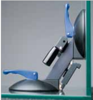
Exacte positionering door parallelle inzet van meerdere zuigers.
