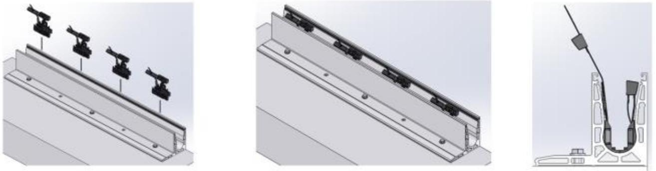
**Figure 32.2 – Montage du système garde-corps Bohle Vetromount F**
