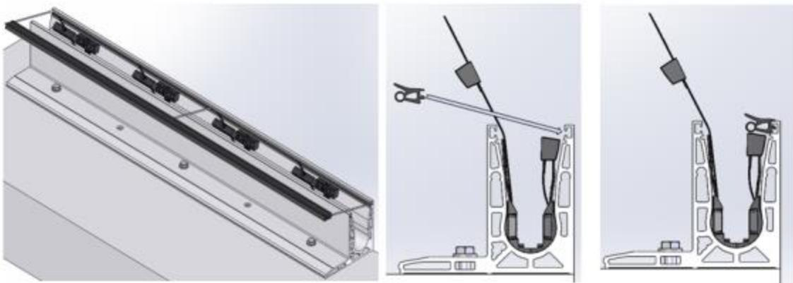
**Figure 32.3 – Montage du système garde-corps Bohle Vetromount**
