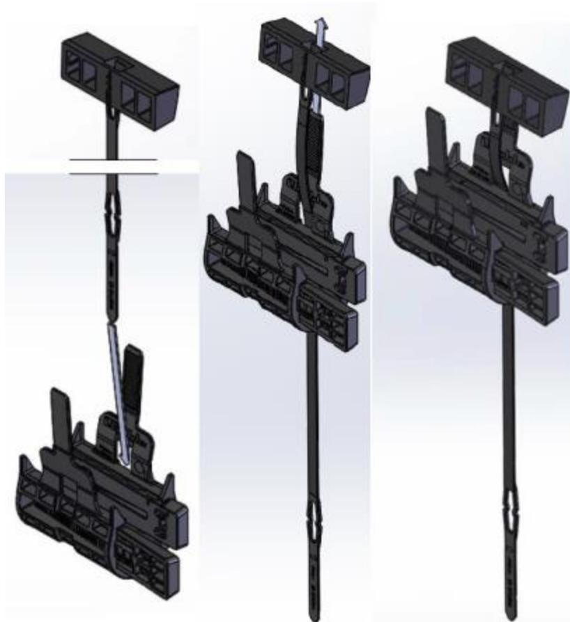
**Figure 31.4 – Montage du système de calage Bohle VetroMount**
