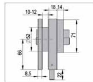
1 Euro-Profilzylinder (verschiedenschließend) 70 mm (35/35) · inkl. Schließblech, Bodenbuchse und Befestigungsschrauben · Glasdicke ESG 10, 12 mm · eine Bohrung im Glas ist für den Einsatz erforderlich
