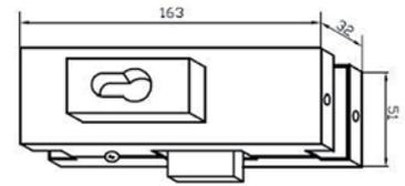
① Euro-Profilzylinder (verschiedenschließend) 60 mm (30/30) · inkl. 4 Schlüssel · inkl. Schließblech und Befestigungsschrauben · Glasdicke ESG 10, 12 mm
