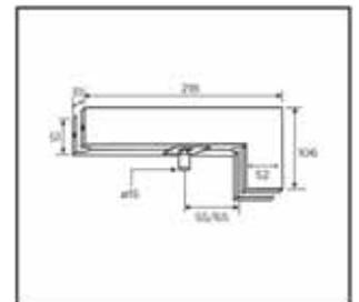
**i** Mit Bolzen  $\varnothing 15$  mm · justierbarer Drehpunkt (55/65 mm) · Glasdicke ESG 10, 12 mm
