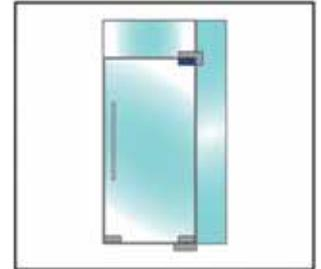
**i** mit Kunststoffbuchse für Bolzendurchmesser 15 mm · justierbarer Drehpunkt (55/65 mm) · Glasdicke ESG 10, 12 mm
