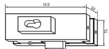
① Euro-Profilzylinder (verschiedenschließend) 60 mm (30/30) · inkl. 4 Schlüssel · Bei einer doppelflügeligen Tür sollte ein Feststeller zusätzlich verwendet werden. · Glasdicke ESG 10, 12 mm
