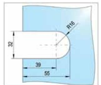
① Bei einer doppelflügeligen Tür sollte ein Feststeller zusätzlich verwendet werden. · Glasdicke ESG 10, 12 mm · Maße 53 x 64 mm · Rundriegel  $\varnothing 7$  mm · 1-tourig / 17 mm Riegelausschluss · einseitig verschließbar · inkl. Schließblech und Befestigungsschrauben
