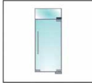
**i** Mit Bolzen  $\varnothing 15$  mm · justierbarer Drehpunkt (55/65 mm) · Glasdicke ESG 10, 12 mm · Anschraubplatte lose beigefügt
