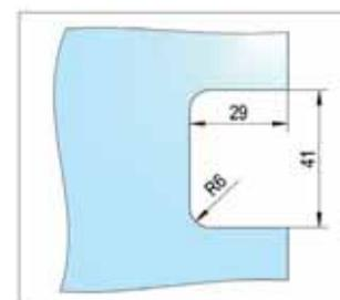
1 Bei einer doppelflügeligen Tür sollte ein Feststeller zusätzlich verwendet werden. · Glasdicke ESG 10, 12 mm · Maße 53 x 40 mm
