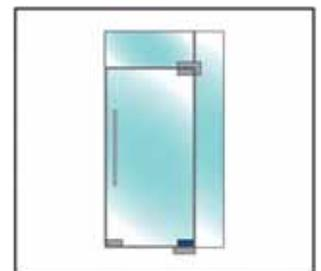
**i** mit Einsatz für flachkonische Achse · justierbarer Drehpunkt (55/65 mm) · Glasdicke ESG 10, 12 mm
