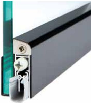
① ideale per la sigillatura di porte in vetro · listelli di tenuta possono essere rifilati, attenzione alla lunghezza minima · per porte DIN sinistro e DIN destro · attivazione unilaterale · Isolamento acustico 41 dB · per 8 - 8,76 mm vetro
