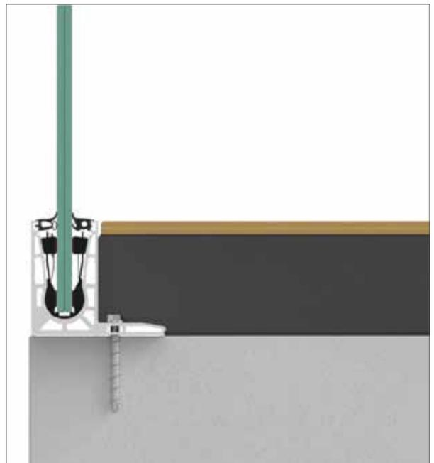
Para un acabado enrasado entre la parte superior del perfil y el suelo, se puede cubrir con pavimento.
